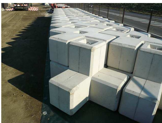
五角ブロックの備蓄状況（隙間なく備蓄できます）
