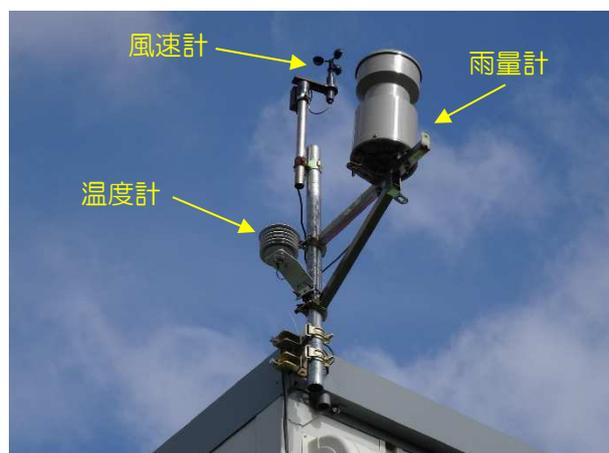
風速計・雨量計・温度計設置例
