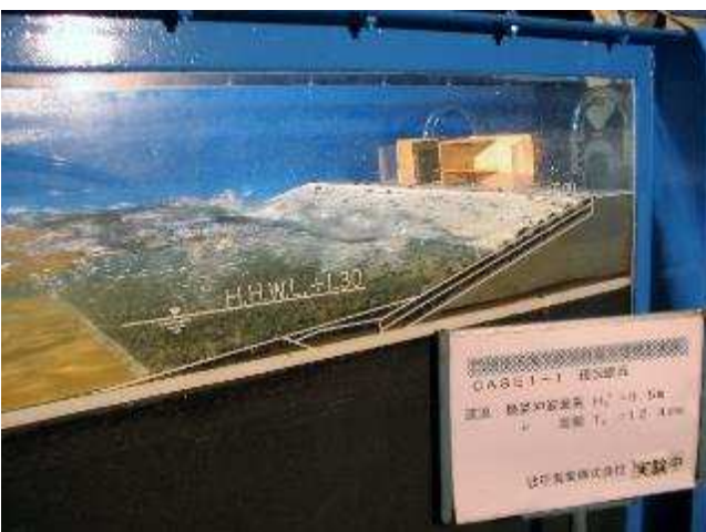
階段護岸ブロックに関する水理実験 （ブロック摩耗時の安定性）
