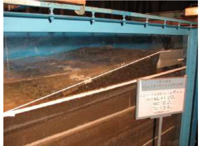
打ち上げ高に関する水理実験 （人工リーフ背後の緩傾斜堤）
