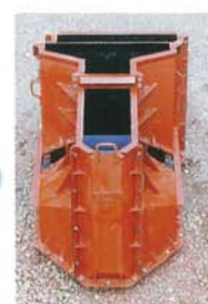
④前板・仕切板組立
