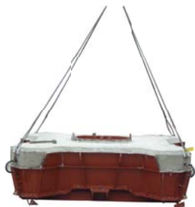
吊り鉄筋押さえ・面取り枠 中筒押さえ 取り外し
